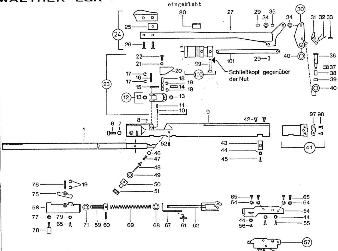
Umbauhinweis: Es darf ein Kolben ohne Tellerfedern nicht mit der neuen Schlageinrichtung kombiniert werden.
