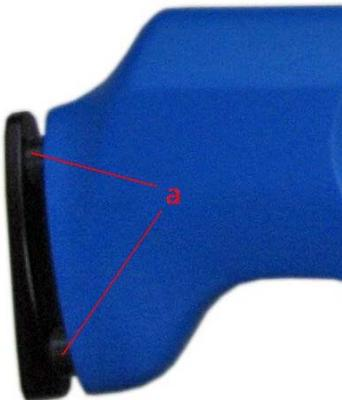
Die Schaftlänge Deines LG3 kann durch Entnahme oder Zufügen der Zwischenstücke (a) verändert werden. Dazu die Befestigungsschrauben entfernen, Zwischenstücke (a) einsetzen oder entfernen und Schaftbacke wieder anschrauben.
