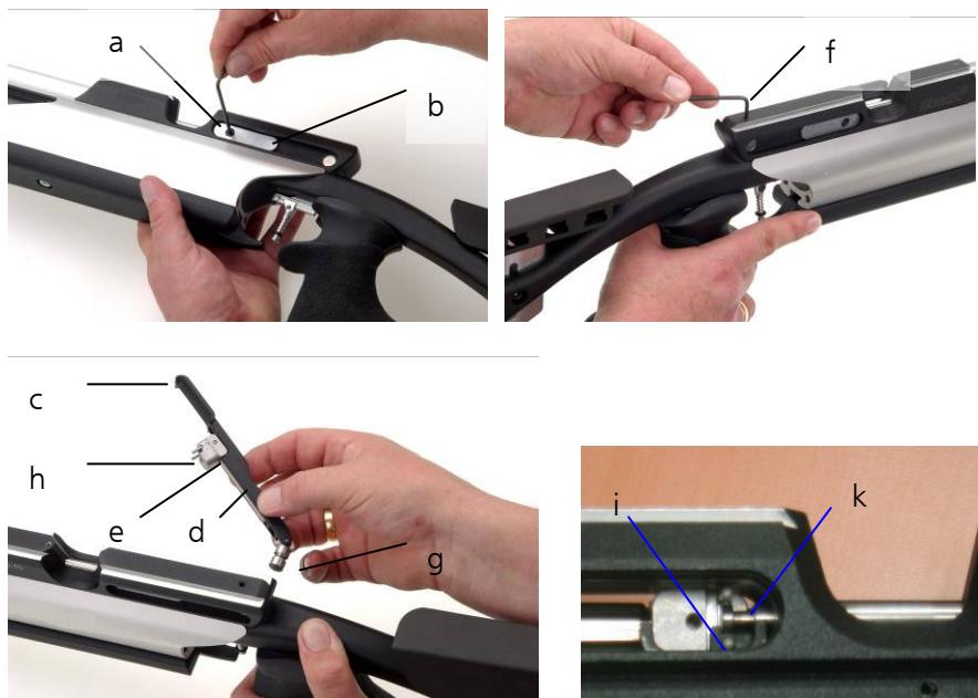
Déchargez l'arme de sport avant de changer le mécanisme de chargement, car un déclenchement involontaire de la détente lorsque le levier de chargement est ouvert peut entraîner des dommages. La vis (a) et le cache (b) peuvent après cela être retirés. Ensuite, faire pivoter simultanément le levier de chargement (c), l'articulation de chargement (d) et le coupleur (e) (de manière analogue au
