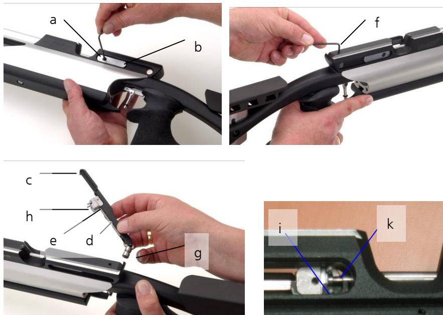
Entladen Sie die Sportwaffe vor dem Wechseln des Lademechanismus, da es durch unbeabsichtigtes Auslösen des Abzuges bei geöffnetem Ladehebel zu Beschädigungen kommen kann. Als nächstes kann die Schraube (a) und die Abdeckung (b) entfernt werden. Danach den Ladehebel (c), das Ladegelenk (d) und das Kupplungsstück (e) zusammen ausschwenken (analog der Ladebewegung). Nachdem die Schraube (f) gelöst ist (ca. 3 Drehungen im Gegenuhzeigersinn),
